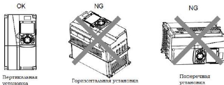
Рис 4.1 Ориентация ПЧ при установке
