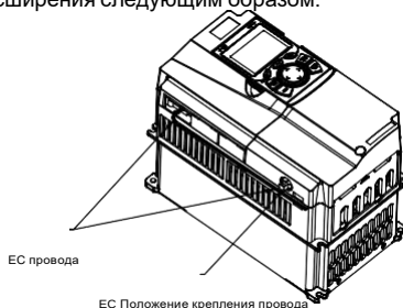
Рис А.5 Прокладка проводов для платы расширения
